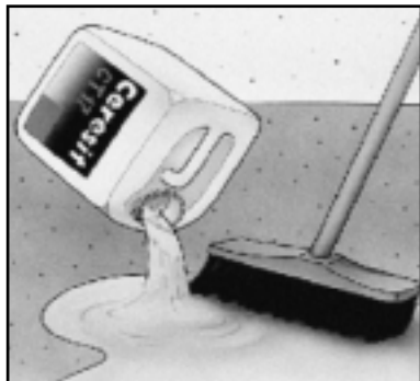
Рисунок 22. Нанесение слоя грунтовки.
